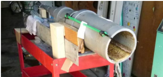
写真1 尿石除去 通水試験状況
